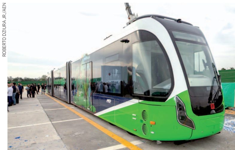
Movido por baterias de íons de lítio de 600 kWh, o veículo BUD pode ser carregado rapidamente nas estações por pantógrafos aéreos (dispositivo instalado no teto de trens e bondes elétricos para coletar energia elétrica da rede aérea)
